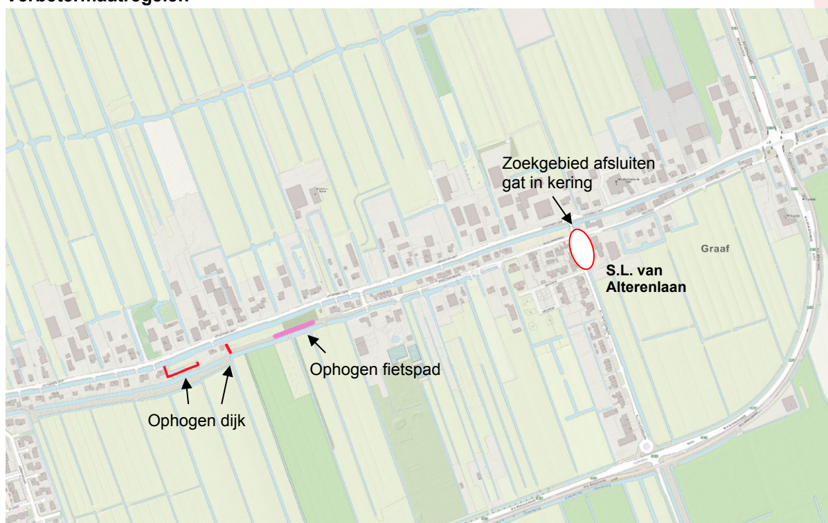
Figuur 20: Verbetermaatregelen voor kadevak 341E. Bij de S.L. van Alterenlaan is de exacte locatie van de maatregel nog niet duidelijk, daar is daarom een zoekgebied aangegeven.
