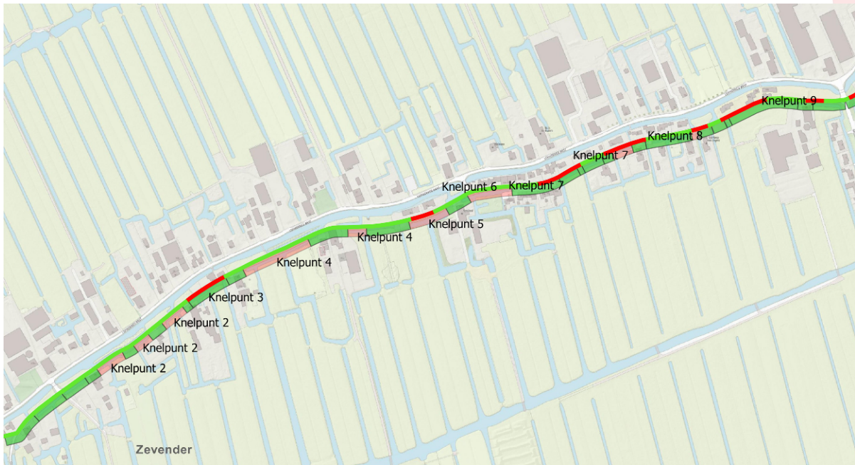
Figuur 5: Eindresultaat toetsing voor kadevak 341B. Op de groene stukken voldoet de dijk aan de veiligheidseisen. Op de rode stukken voldoet de dijk niet aan de eisen voor stabiliteit binnenwaarts en/of hoogte.
