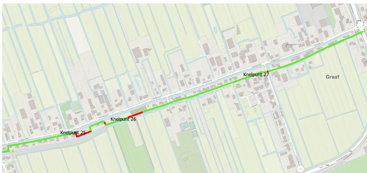
Figuur 19: Eindresultaat toetsing voor kadevak 341E. Op de groene stukken voldoet de dijk aan de veiligheidseisen. Op de rode stukken voldoet de dijk niet aan de eisen voor hoogte.
