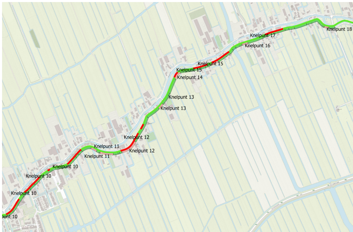
Figuur 10: Eindresultaat toetsing voor kadevak 341C. Op de groene stukken voldoet de dijk aan de veiligheidseisen. Op de rode stukken voldoet de dijk niet aan de eisen voor stabiliteit binnenwaarts en/of hoogte.
