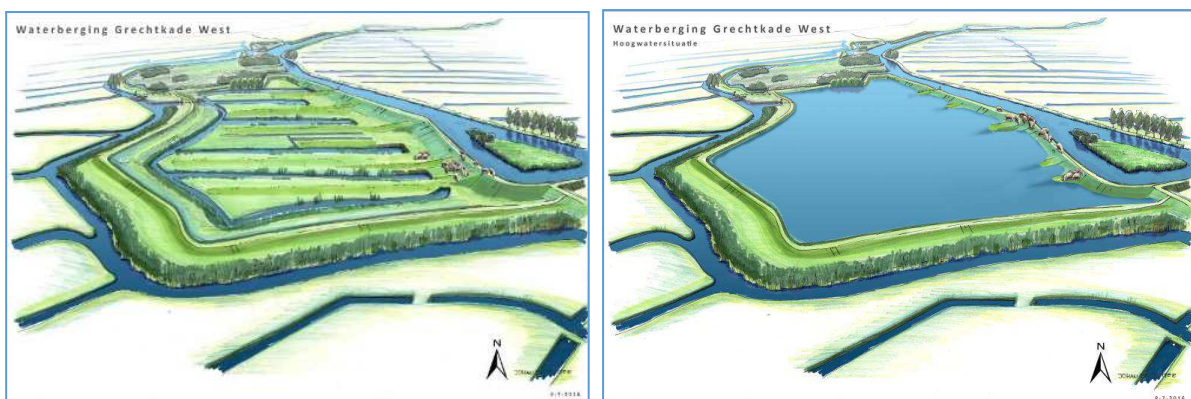
Figuur 5: Illustratie van de lege en volle waterberging
