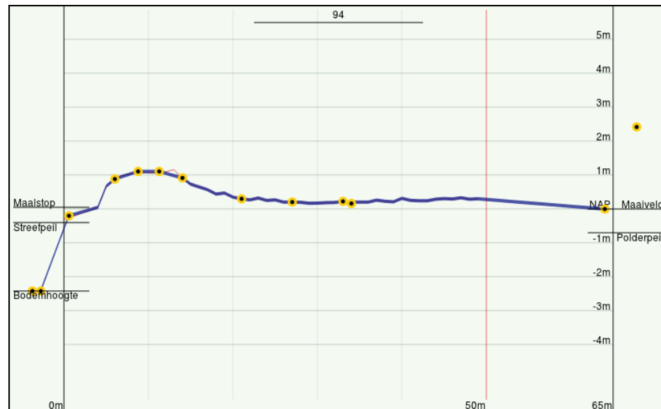
Figuur 3-1: Dwarsprofiel op basis van AHN-2 en aanvullende gegevens (maaiveld polder en waterbodemoogte). Maalstoppeil, streefpeil en polderpeil zijn ter controle gebruikt.
