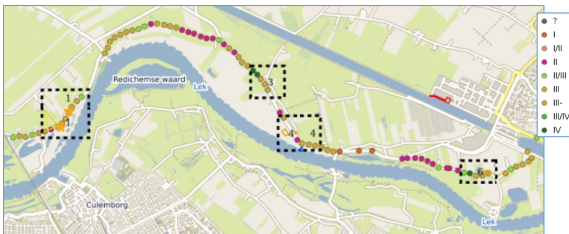
Figuur 3-4 De staat van de kruidenrijkdom van de dijk binnen het plangebied. Bron (Polderprof, 2025). In de vierkante stippelijnen zijn de locaties van de te treffen maatregelen voor de dijkverbetering aangegeven.
