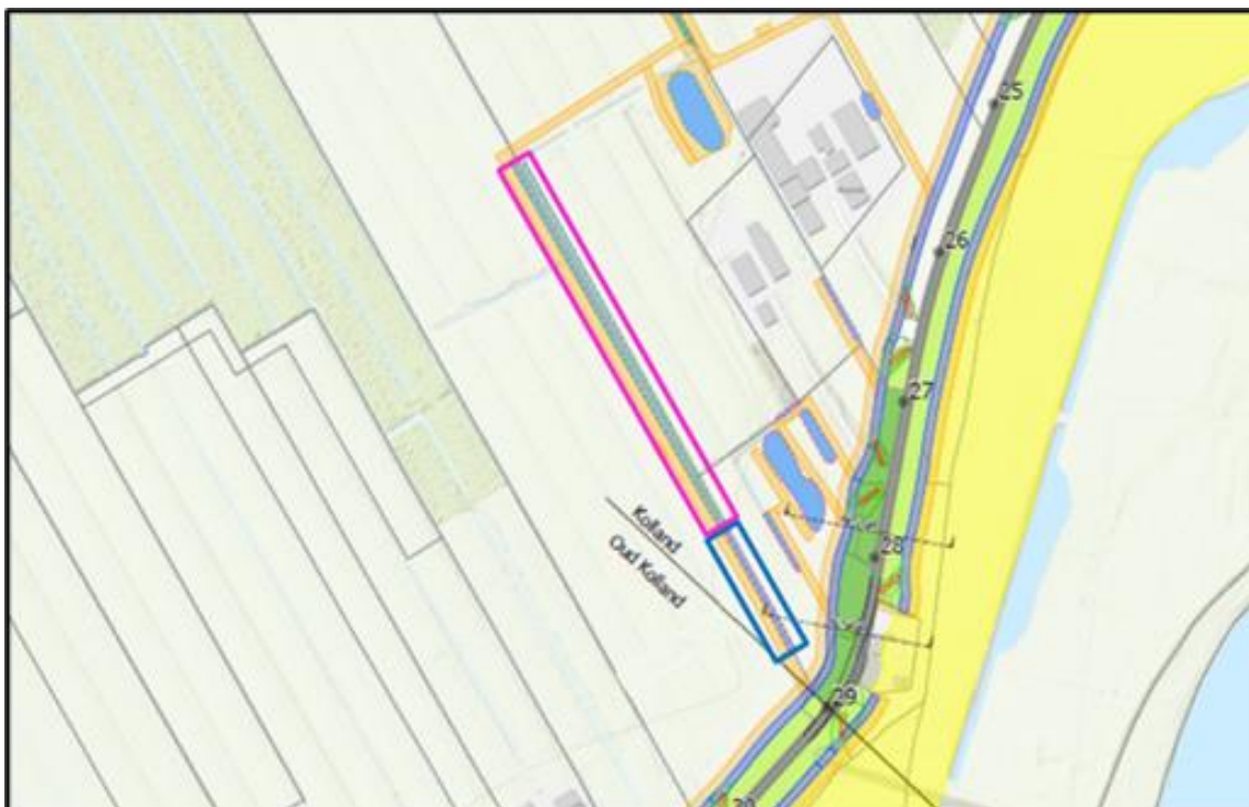
Figuur 1-1 Aanpassingen ten opzichte van het basisontwerp die zijn opgenomen in het 'nieuwe basisontwerp'. De sloot die wordt vervangen door buisdrainage is blauw omcirkeld; Taludverflauwing (=slootcompensatie) vindt plaats in het roze omcirkelde gebied.
