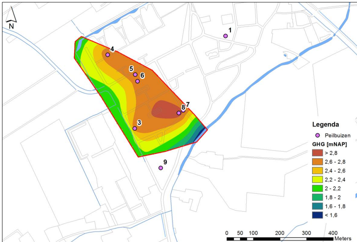
Figuur 3-4 GHG in m+NAP (deze is afgeleid van de gemeten grondwaterstanden en het omliggende oppervlaktewaterpeil)
