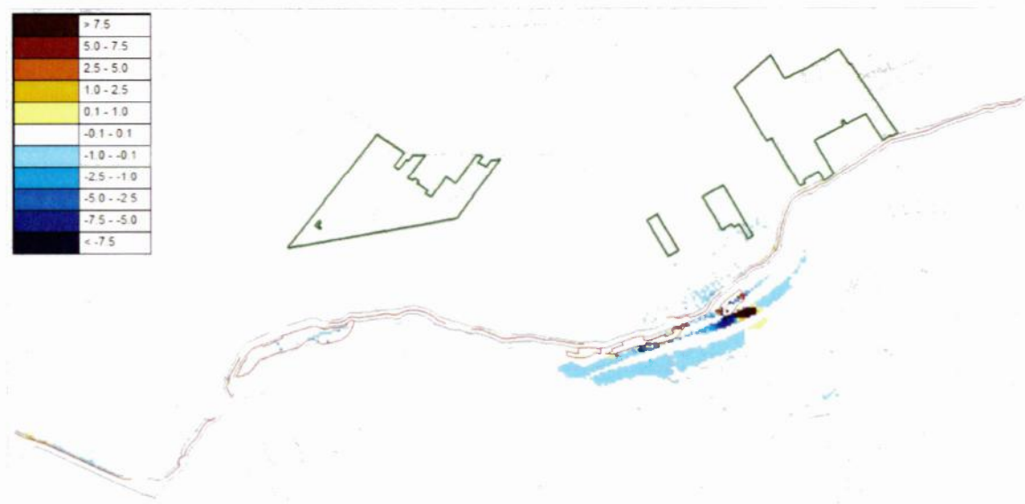
Afbeelding 5.5 Effect (mm/d) op de afvoer van het basisscenario t.o.v. de referentie (SCEN2A_HFB2 – REF2_BAS)
