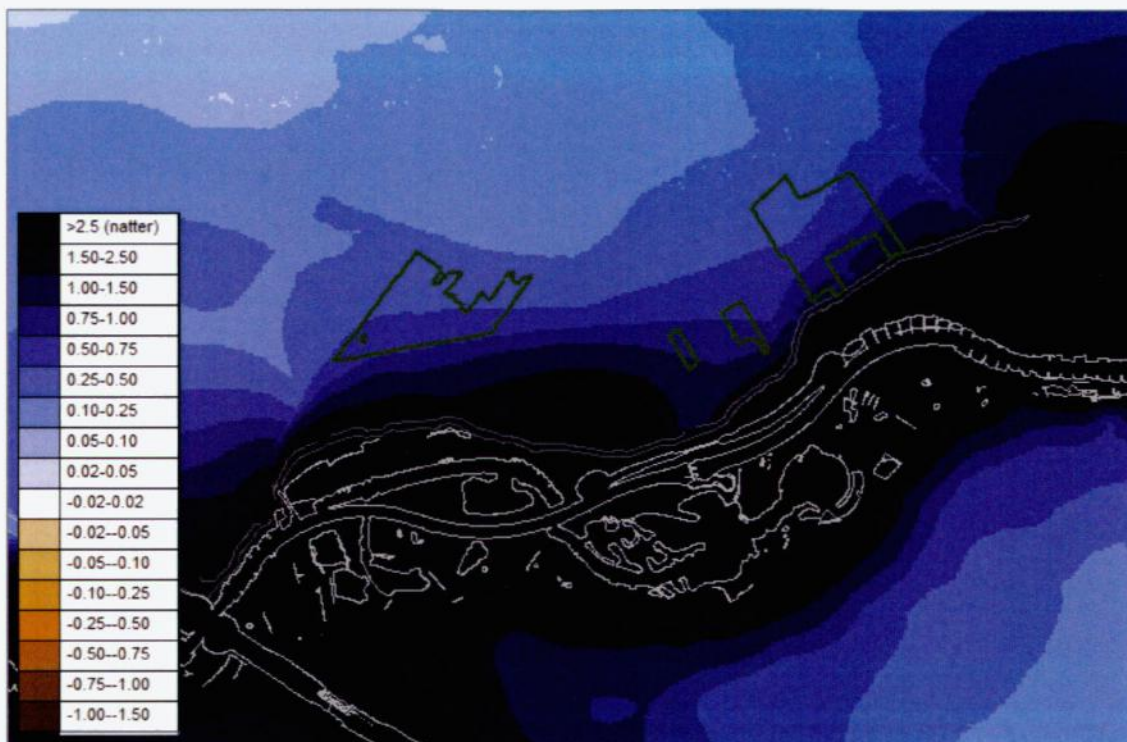
Afbeelding B2.2 Effect (m) van hoogwatersituatie op stijghoogte in WVP1 (L3) (REF2_HW85 - REF2_BAS)
