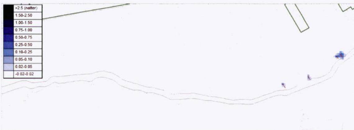
Afbeelding 5.15 Effect (m) op de freatische grondwaterstand door dempen kopsloten (SCEN2B_BAS-REF2_BAS)
