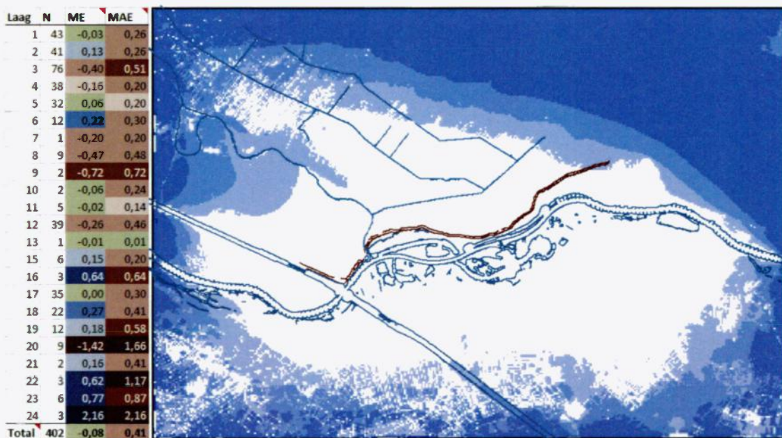
Afbeelding B1.20 Residustatistiek voor SHD-grids van ruimer model en effect (m) in L1-5 bij verhoging van alle SHD-grids met gemiddelde afwijking van 0,5m.
