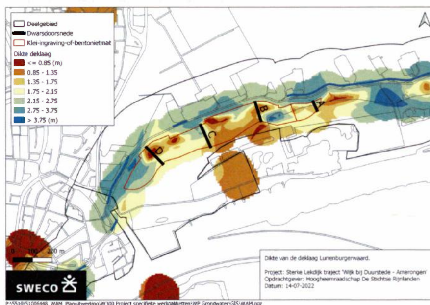
Figuur 3: Dikte van de deklaag beneden 80 cm-mv nabij de Hank (Bovenpolder). Bron: (B-Ware, 2021).
