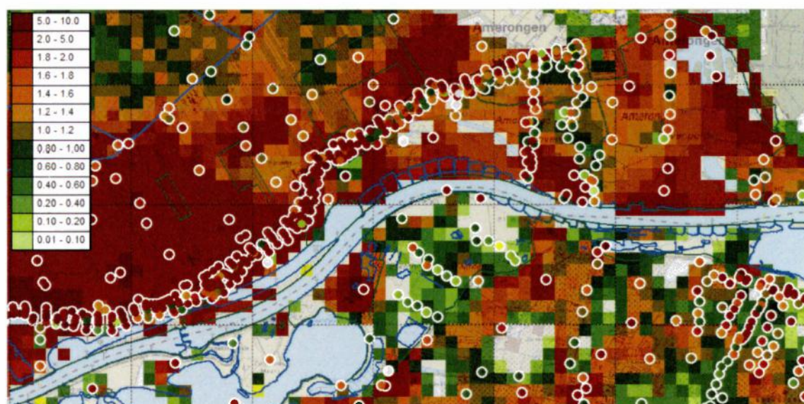
Afbeelding B1.5 Dikte (m) deklaag na correctie o.b.v. boringen DINOloket + WAM
