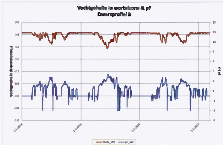
Figuur 11: Dwarsprofiel B: berekend vochtgehalte in de wortelzone (Theta_WZ) en de berekende pF (pF_WZ).
