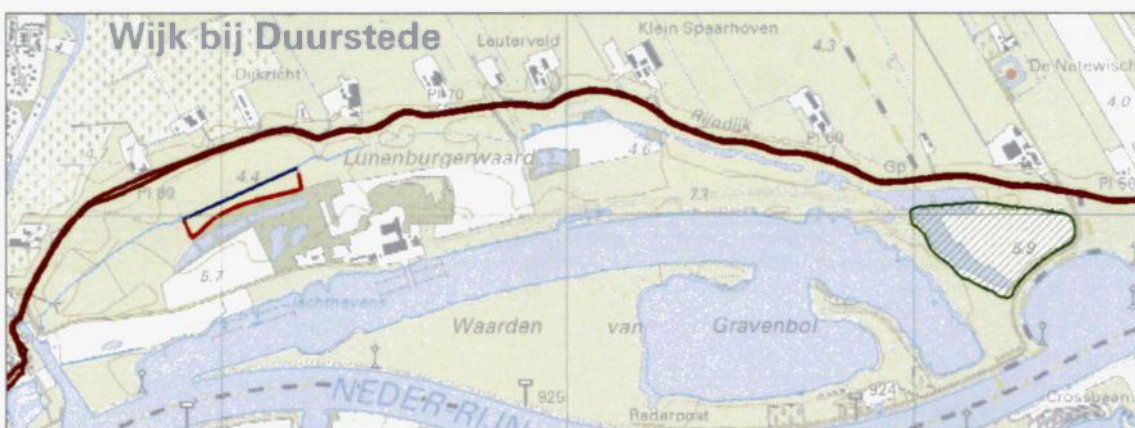
Afbeelding 3.15 Relevante autonome ontwikkelingen: slootverlegging (blauw lijn i.p.v. rode lijn) voor herinrichting Lunenburgerwaard en ontgraving van een kleilaag ter plaatse van Sandenburgerwaard (groen, gearceerde vlak).
