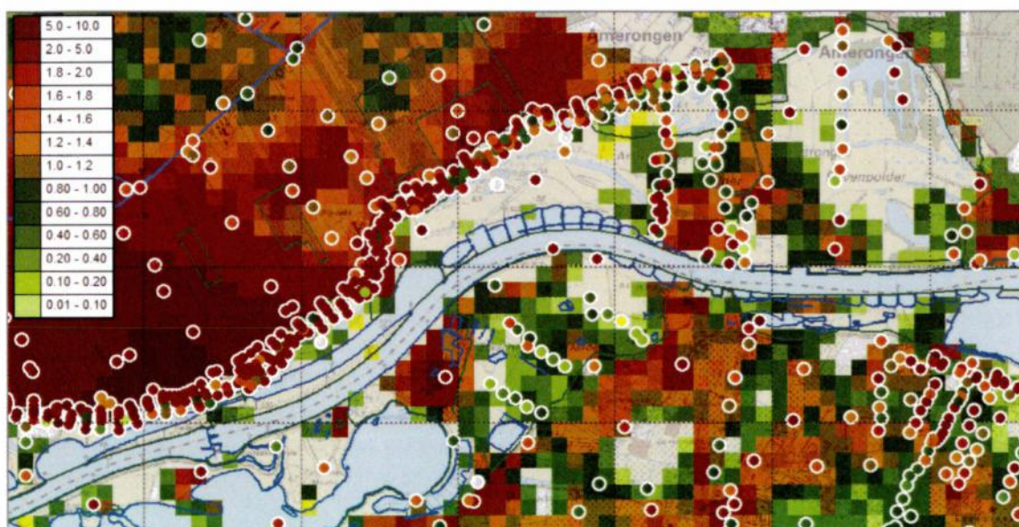
Afbeelding B1.4 Dikte (m) deklaag o.b.v. REGIS/GeoTOP (grid) + boringen DINOloket + WAM
