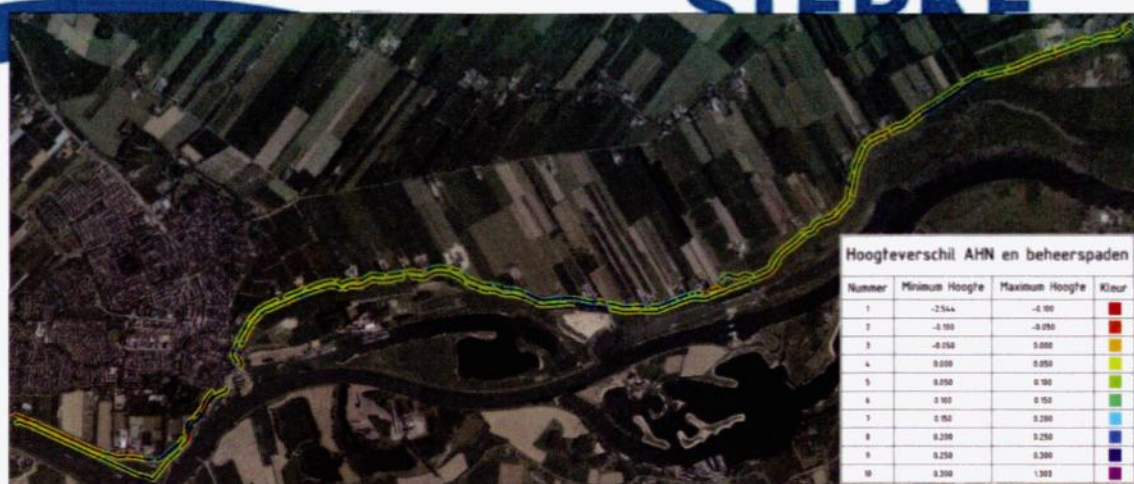
Figuur 2.2.1. Hoogteverschil tussen huidige AHN3 en de aan te leggen beheerspaden. Op basis van "Praatprent-052 versie 0.1".
