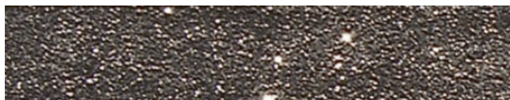
Referentiebeeld voor de coating van de rijloper met een glasparels
