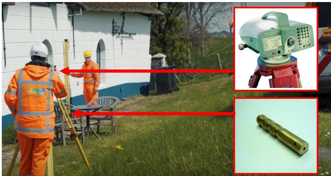
Figuur 10, Voorbeeld zettingsmeting bij woning op ander dijkversterkingsproject.
