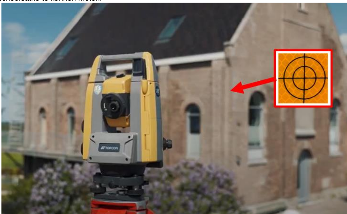
Figuur 11, Voorbeeld total station en meetpunt. Voor dit project kunnen andere meetpunten worden gebruikt.
