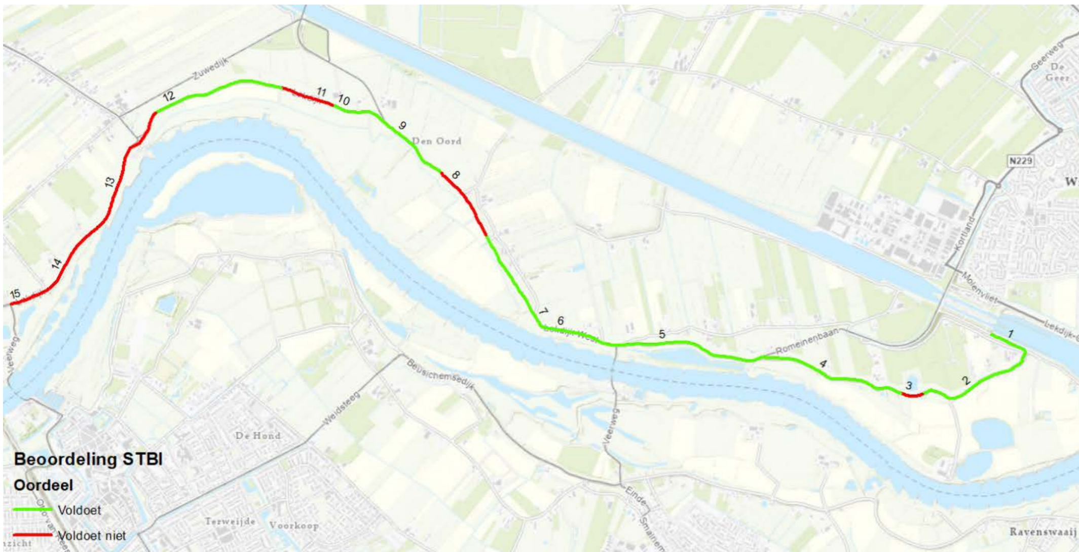
Figuur 3.8: Beoordeling macrostabiliteit binnenwaarts technische dijkvakken (dijkpaal 106 tot en met 204)
