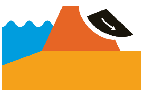
Afschuiving van het talud
