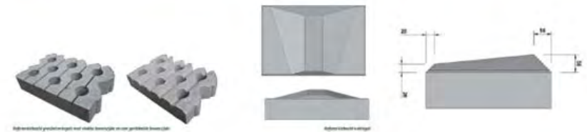
Bermverharding van grasbetonstenen en noktegels
