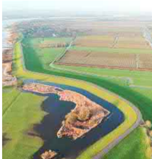
Twee van de drie wielen bij Jaarsveld, dijk met dubbele steunberm
