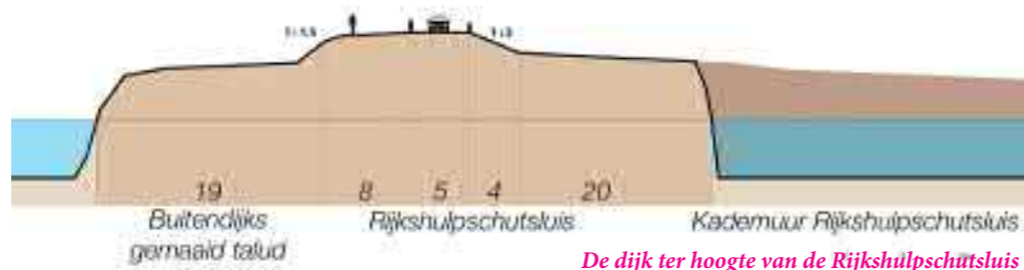
De dijk ter hoogte van de Rijkshulpschutsluis
