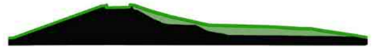
Dijkverzwaringen in de Lopikerwaard in 1987, met in groen de verbreding.
