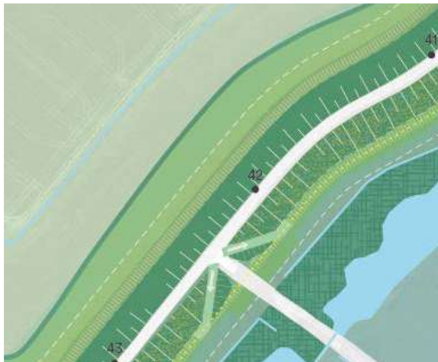
Beheerafrit t.p.v. een haakse perceel- of erfafrit. De beheerafrit vormt een kleine uitstulping aan de dijk
