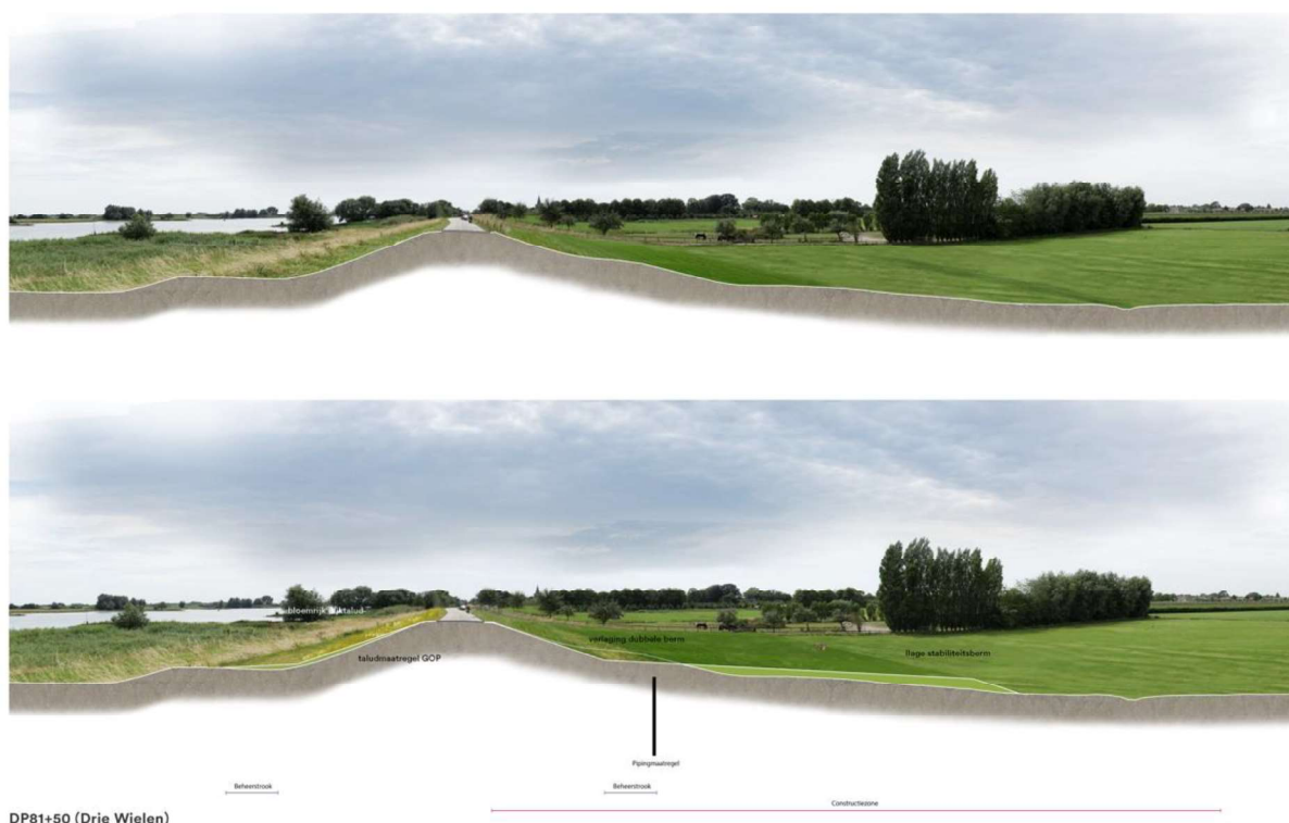
Figuur 3.7 Aanzicht dijkvak De Drie Wielen (DP81+50) min de huidige situatie (boven) en de nieuwe situatie (onder)
