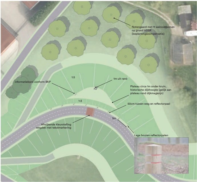
KK - VERPLAATSING GRENSPALEN, MARKEREN UITEINDE IJSSELDAM
