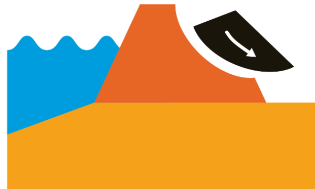
Afschuiving van het talud
