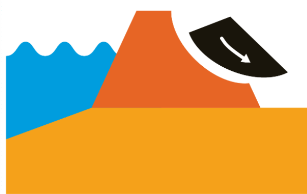
Afschuiving van het talud
