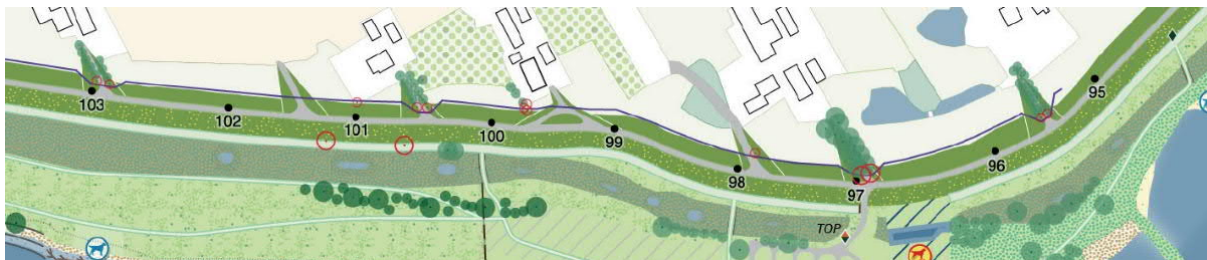
Figuur 6 Kleiputten locatie aan de teen van de dijk (lichtblauwe kleine cirkels ten zuiden van de dijk) .
