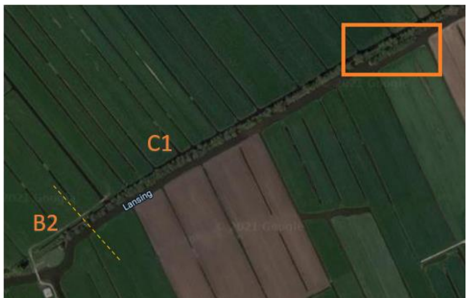
Figuur 17 Ter plaatse van het eilandje in de Lansing (oranje vierkant) wordt meer slib weggehaald dan op de rest van het deeltraject.
