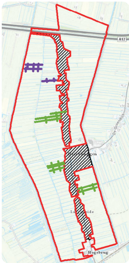
Figuur 11 Kaart locaties maaiveldhoogteraaien (groen=met waterinfiltratiesysteem, paars=zonder waterinfiltratiesysteem)
