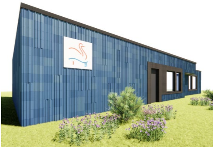
Figuur 3: Ontwerp gevelpanelen van cellulose voor bedrijfsgebouwen
