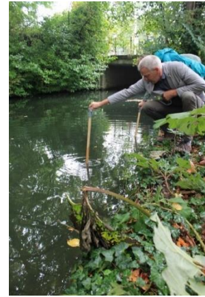
Meten van de diepte van de watergang met een meethark
