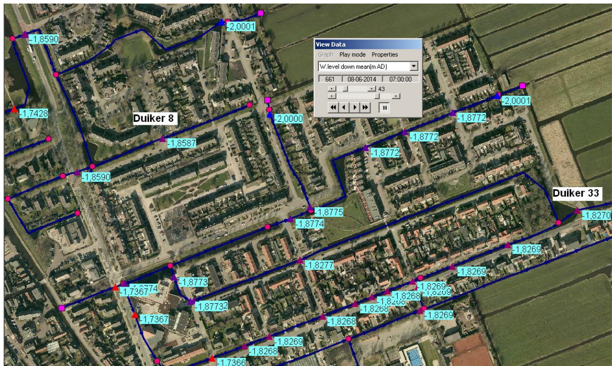
FIGUUR 12: WATERSTAND BENEDENSTROMS BIJ NORMAFVOER
