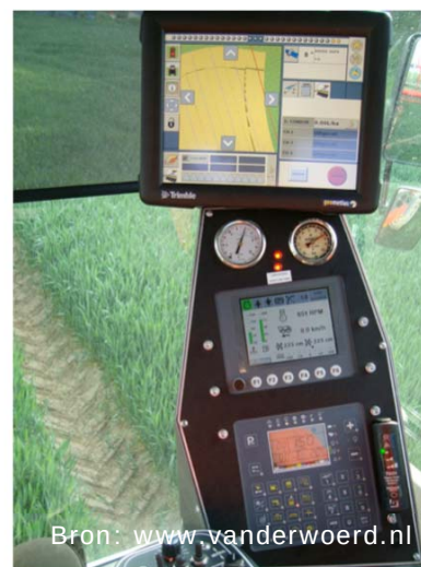
Figuur 3.1 De boordcomputer regelt automatisch het sluiten en openen van de spuitsecties.
