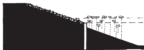
zware beschoeiing met stortsteen of basalt
