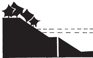
lichte beschoeiing 30 cm onder laag peil
