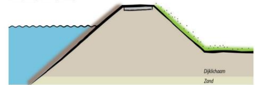
Piping Kwielweg verlengen: Keilaag buitenzijde
