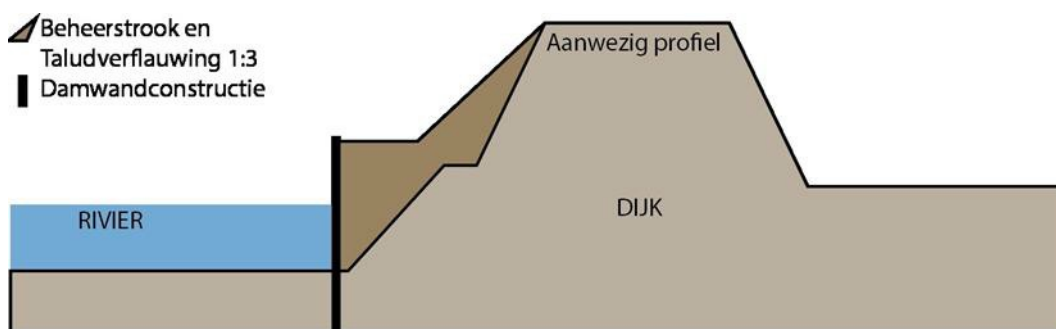
Figuur 2.7 - Dijkzone Schaardijk - variant damwandconstructie
