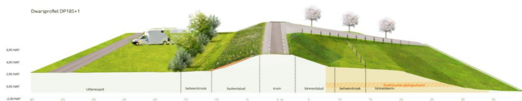
Figuur 3-9 DP185+1 Kruinverhoging en verflauwing talud in combinatie met beheermaatregelen ter hoogte van camping
