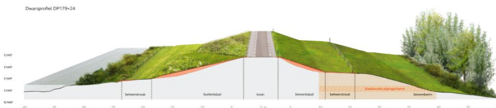
Figuur 3-8 DP180 Pipingscherm in combinatie met beheermaatregelen
