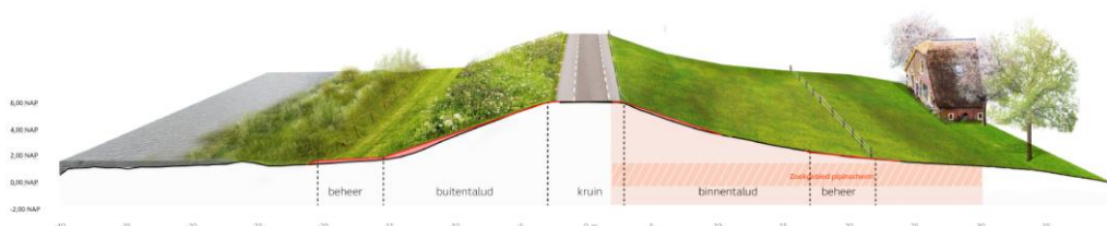
Figuur 3-2 DP 125+4 pipingscherm in combinatie met beheermaatregelen
