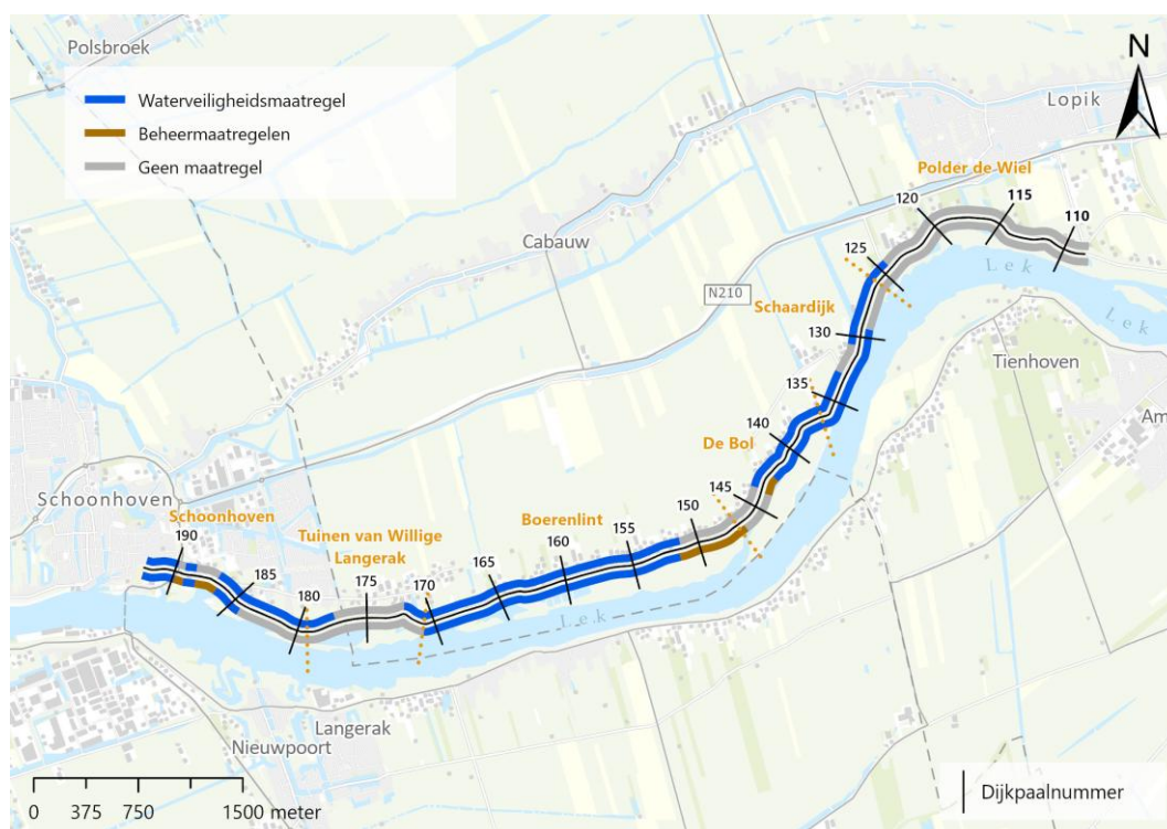
Figuur 3-1 Overzicht waterveiligheids- en beheermaatregelen (Bovenste lijn: binnenzijde dijk. Onderste lijn: buitenzijde dijk)
