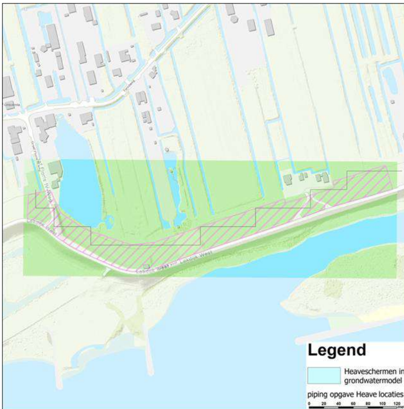
Figuur 2-2 Detail van de ligging van een piping scherm in het grondwatermodel (zwarte lijn) in het beoogde schermgebied (gearceerd gebied).
