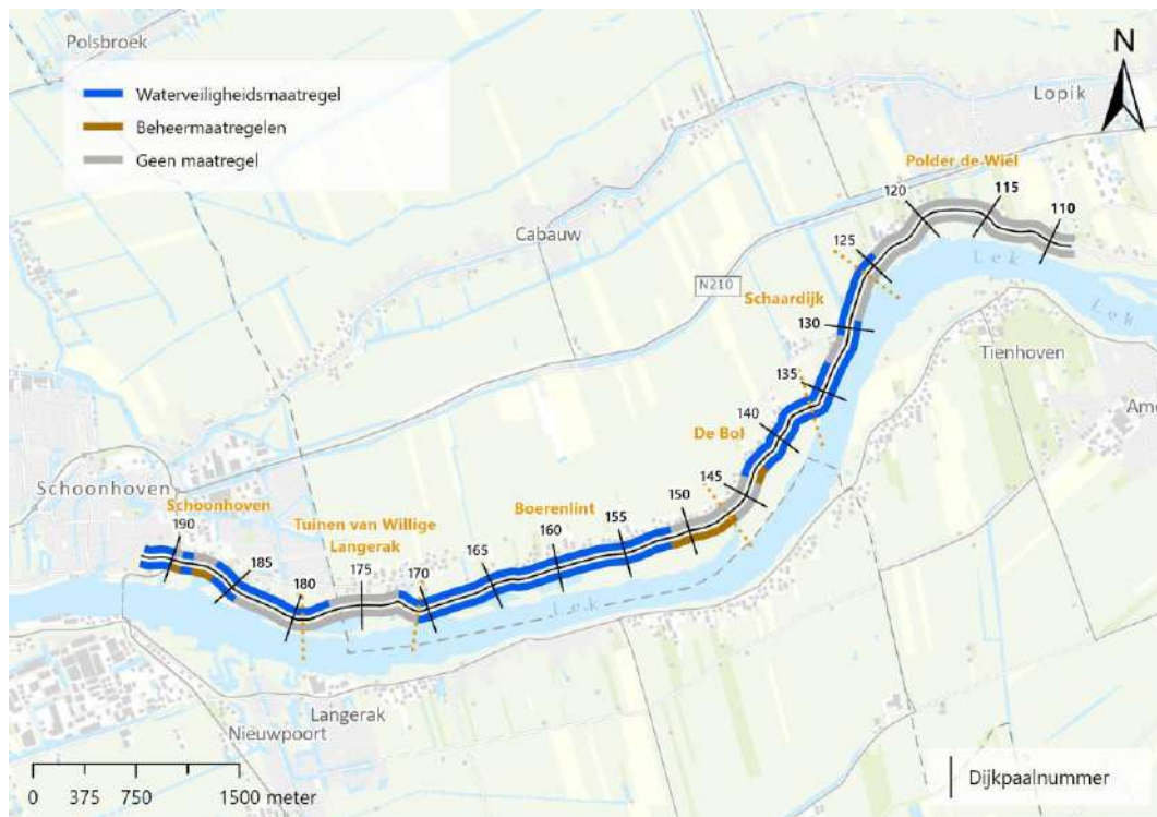
Figuur 1.3 | Overzicht waterveiligheids- en beheermaatregelen (Bovenste lijn: binnenzijde. Onderste lijn: buitenzijde)
