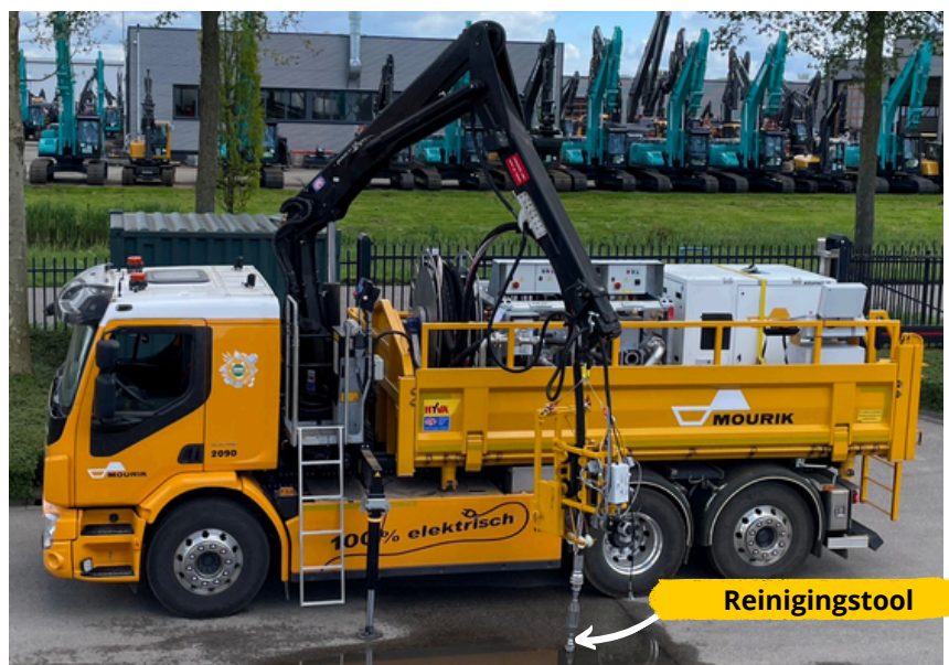
Foto 2: Prolock Equipment: speciaal ingericht materieel om de vijf 'installatie'-stappen te doorlopen.
