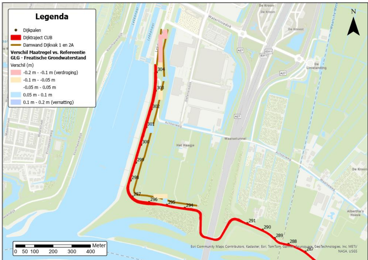
Figuur 5-7 Berekend effect van de damwanden in dijktrajecten 1 en 2b op de freatische grondwaterstand (GLG).
