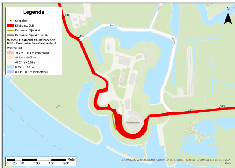
Figuur 5-6 Berekend effect van de damwanden in dijktraject 6 op de freatische grondwaterstand GHG.
