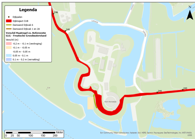
Figuur 5-6 Berekend effect van de damwanden in dijktraject 6 op de freatische grondwaterstand GHG.
