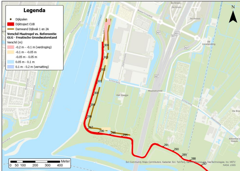
Figuur 5-3 Berekend effect van de damwanden in dijktrajecten 1 en 2b op de freatische grondwaterstand GLG
