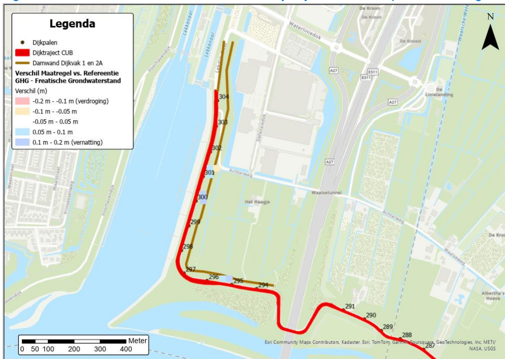
Figuur 5-4 Berekend effect van de damwanden in dijktrajecten 1 en 2b op de freatische grondwaterstand GHG
