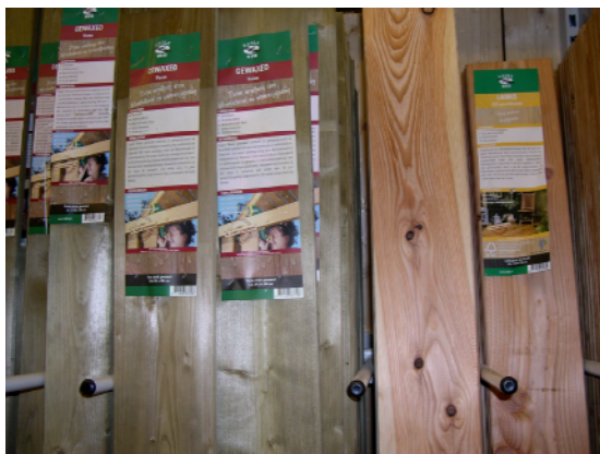
Gewaxed vurenhout (links) en lariks (rechts). Beide gaan buiten onbehandeld zo'n 15 jaar mee.
