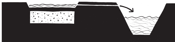
figuur 3.5 Overstort van een infiltratievoorziening op een wijkwatergang (principeschets)
