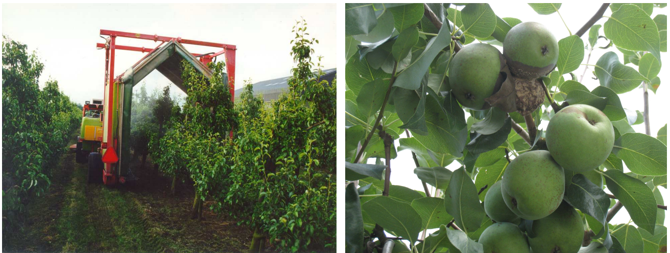
Figuur 2.10 Gebruik van een tunnelspuit in de fruitteelt. Weinig drift!
