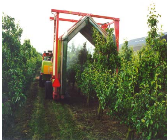
Fig. 2.13 Toepassing van gewasbeschermingsmiddelen m.b.v. een tunnelspuit. Minimale drift.
