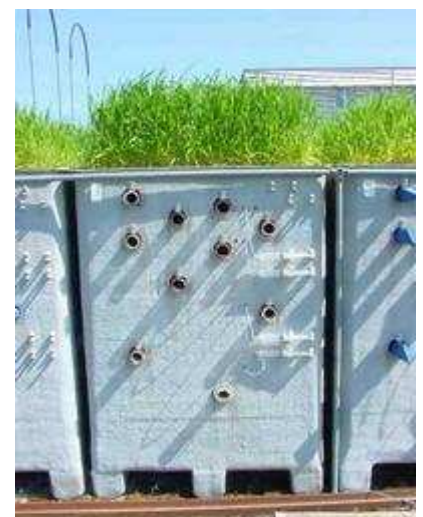
Figuur 3.3: Een lysimeter zoals die gebruikt wordt om verdamping te meten
